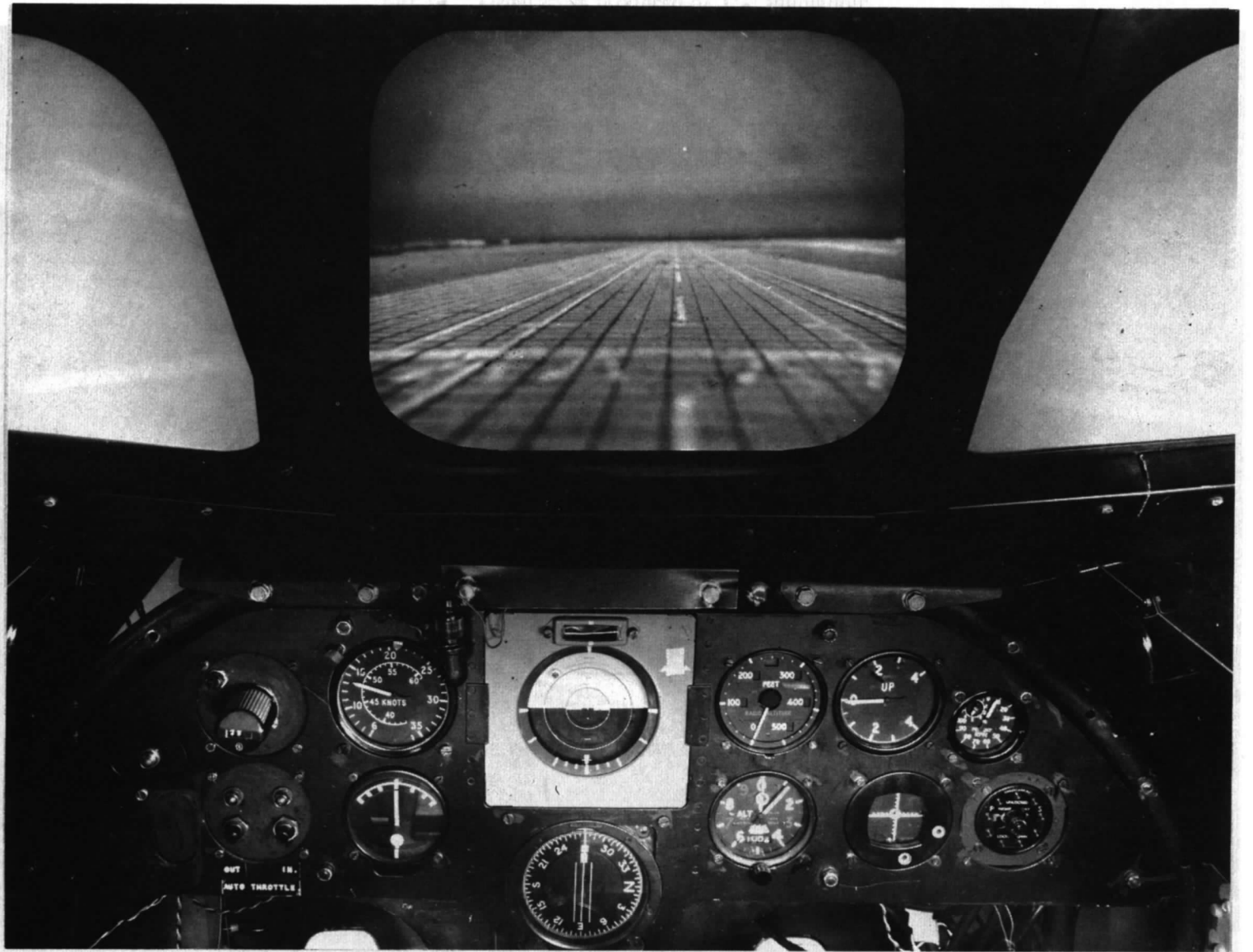
FIG. 23. T.V. visual simulation displayed in cockpit.
